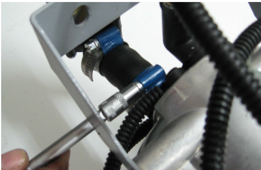
Рис. 38. Демонтаж жидкостного патрубка
