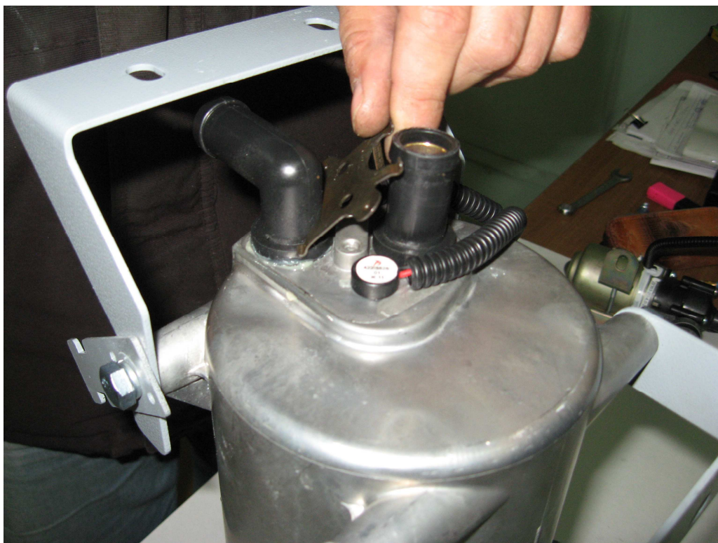
Рис. 30. Демонтаж прижима пружинного
