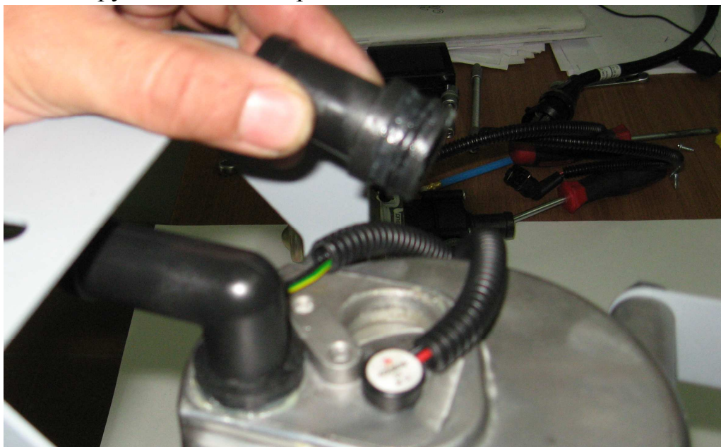
Рис. 32. Демонтаж жидкостного патрубка
