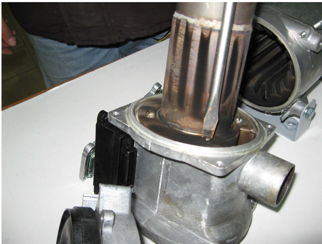
Рис. 21. Демонтаж камеры сгорания
