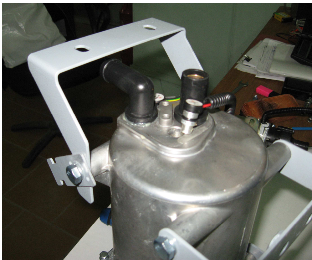
Рис. 31. Демонтаж датчика температуры
