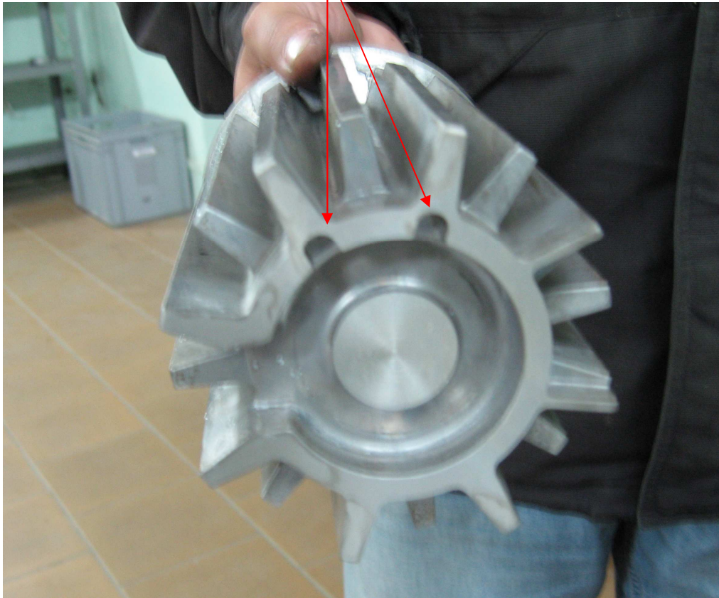
Рис. 26. Вид с торцевой части теплообменника
