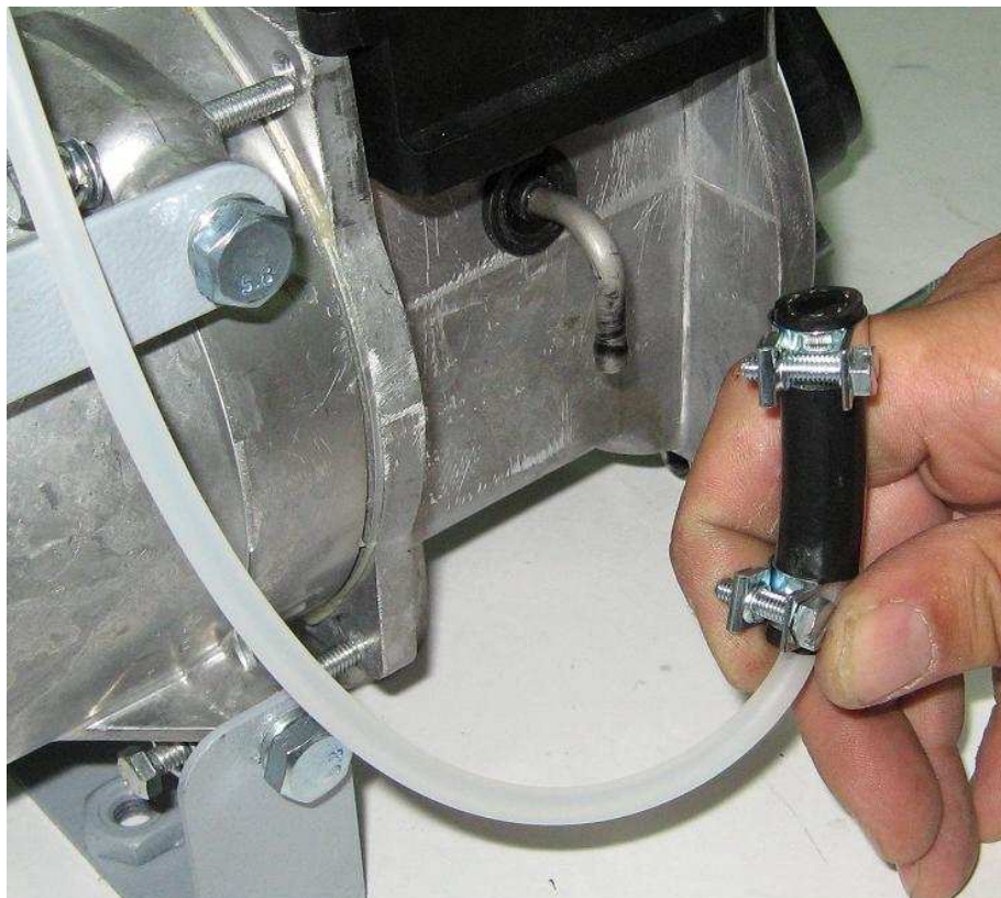
Рис. 35. Демонтаж топливной магистрали с топливопровода подогревателя. - шлицевой отверткой ослабить стяжные хомуты на топливопроводах и снять их (см. рис. 35);
