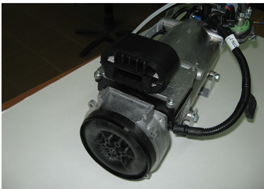
Рис. 42. Демонтаж фильтра воздушного.
