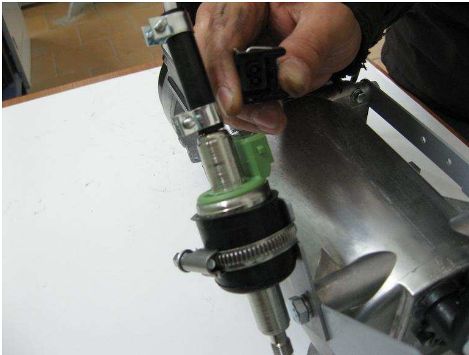
Рис. 34. Демонтаж колодки жгута питания
